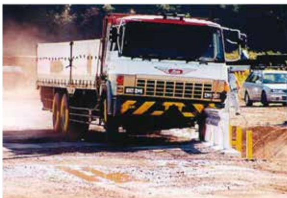
トラック衝突時（直接基礎上）
