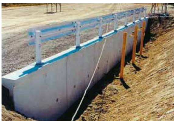
衝突実験前（直接基礎上）
